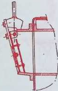
PINTU BAHAN BAKAR DENGAN ENGSEL HORIZONTAL UNTUK KAPAL LAUT
