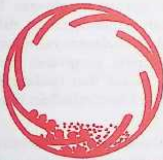
Gilingan batubara jenis silindris atau tromol
